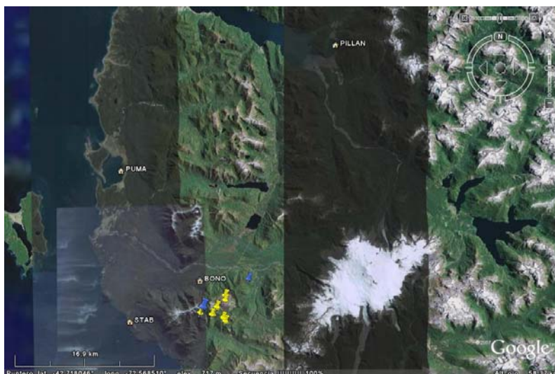
Figura 1. Localización de epicentros calculados desde el día 26.09 al 02.10.2008. Los punteros amarillos corresponden a sismos de tipo HB, mientras que los azules a sismos de tipo VT. Sus profundidades se centran entre los 0 y 5 km bajo la caldera.
